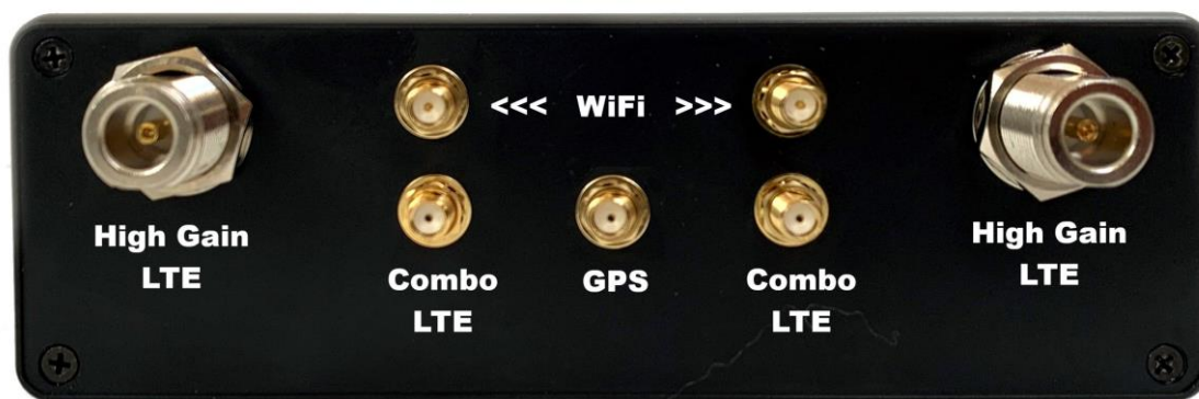
Figura 2 - Posizione dei connettori
